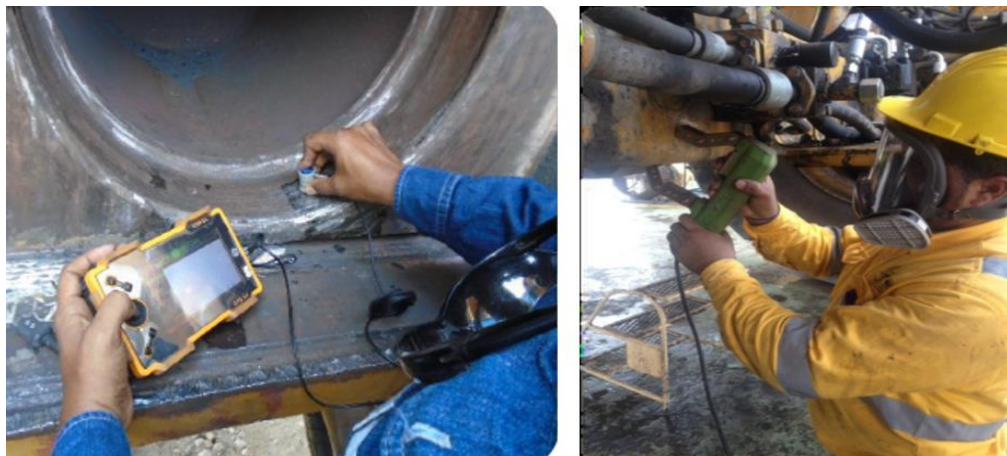
Figura 35. Ensayos con ultrasonido y partículas magnéticas
