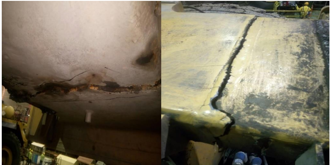
Figura 10. Evidencias Fotográficas de Grietas Chasis 1
