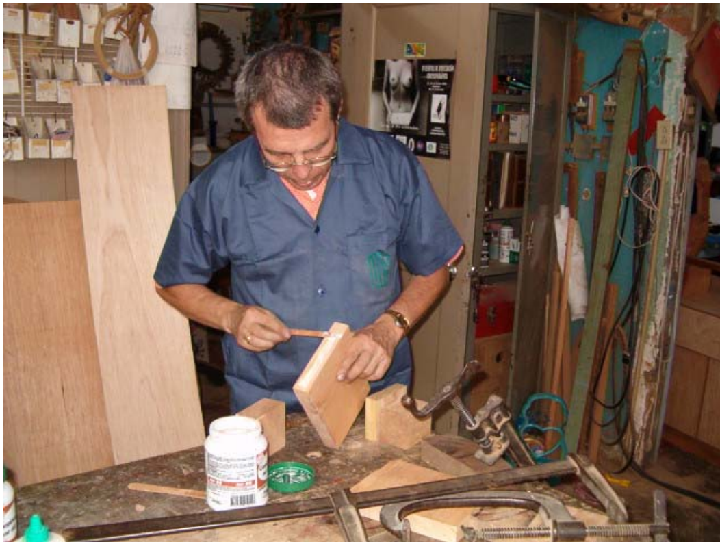
Fotografía 4. Pega de la obra
