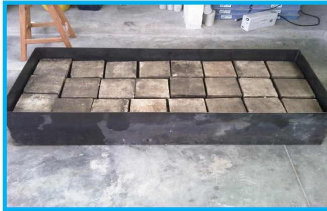
Figura 13. Piscina de inmersión para las probetas
