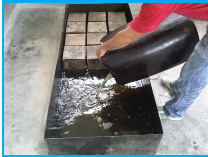
Figura 14. Inmersión de las probetas en contacto directo con el biodiesel
