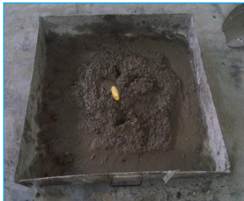
Figura 6. Mezcla de cemento, agregado grueso, fino y agua
