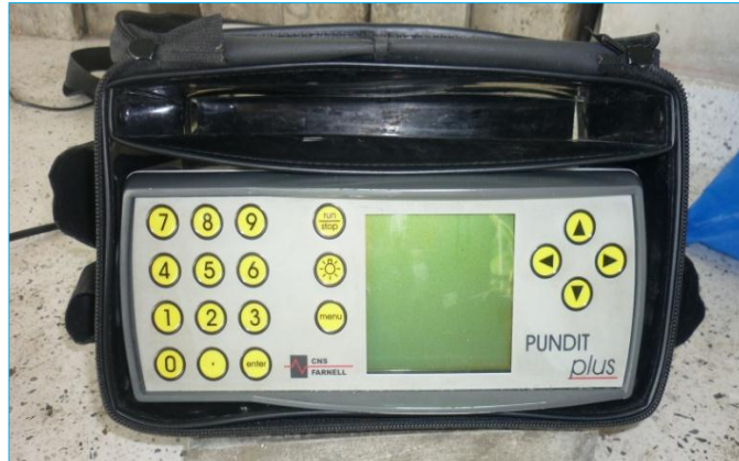
Figura 9. Equipo de Ultrasonico de Baja Frecuencia marca CNS Farnell Limited Tipo PUNDIT PLUS Modelo PC1006
