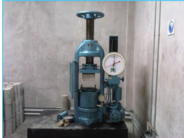
Figura 11. Máquina universal de ensayos AMSLER
