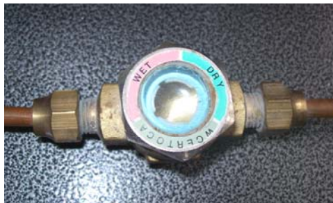
Figura 19. Visor ubicado en la línea de líquido
