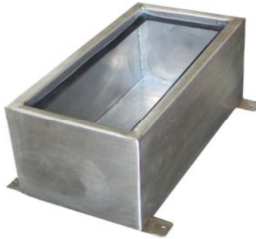
Figura 52. Fabricación del tanque de descarche.
