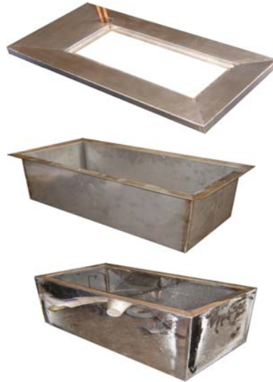
Figura 46. Fabricación del conjunto Tanque para refrigerante secundario.
