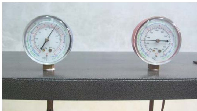
Figura 26. Manómetros de alta y de baja presión.
