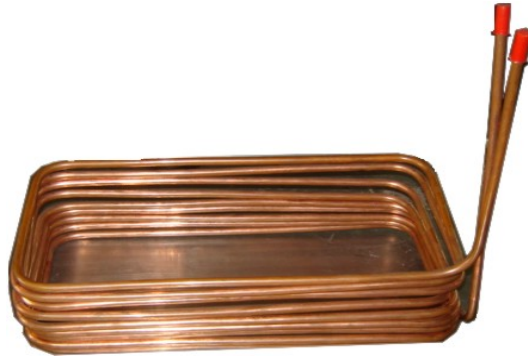
Figura 54. Fabricación del serpentín.
