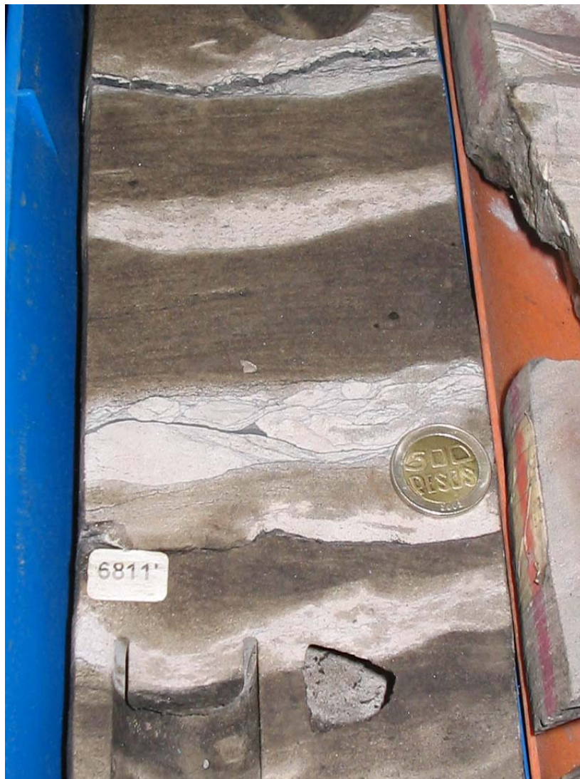
Figura 30. Intercalación de niveles de alta y baja permeabilidad con saturación y no saturación de HC, respectivamente, en el pozo Castilla – 18.
