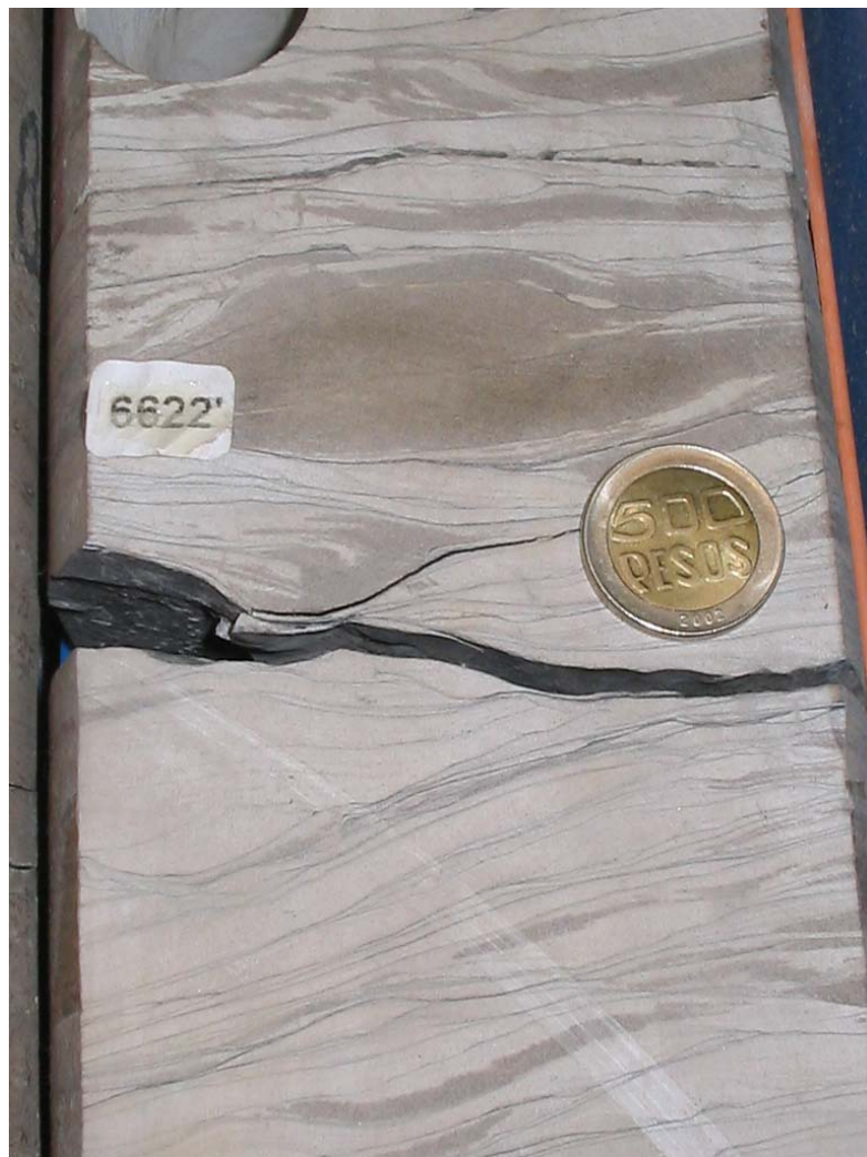
Figura 32. Lente arenoso con saturación regular de HC dentro de unas areniscas de grano fino con alto contenido de matriz.
