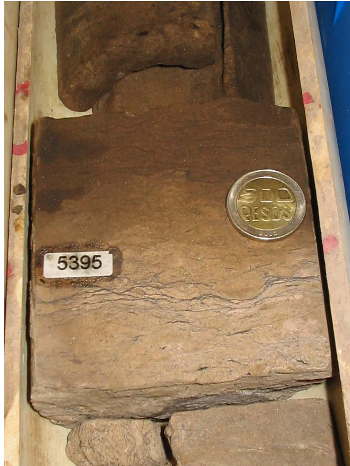
Figura 33. Barrera de permeabilidad dada por el aumento del contenido de matriz limosa y arcillosa dentro de la misma arenisca de grano muy fino.
