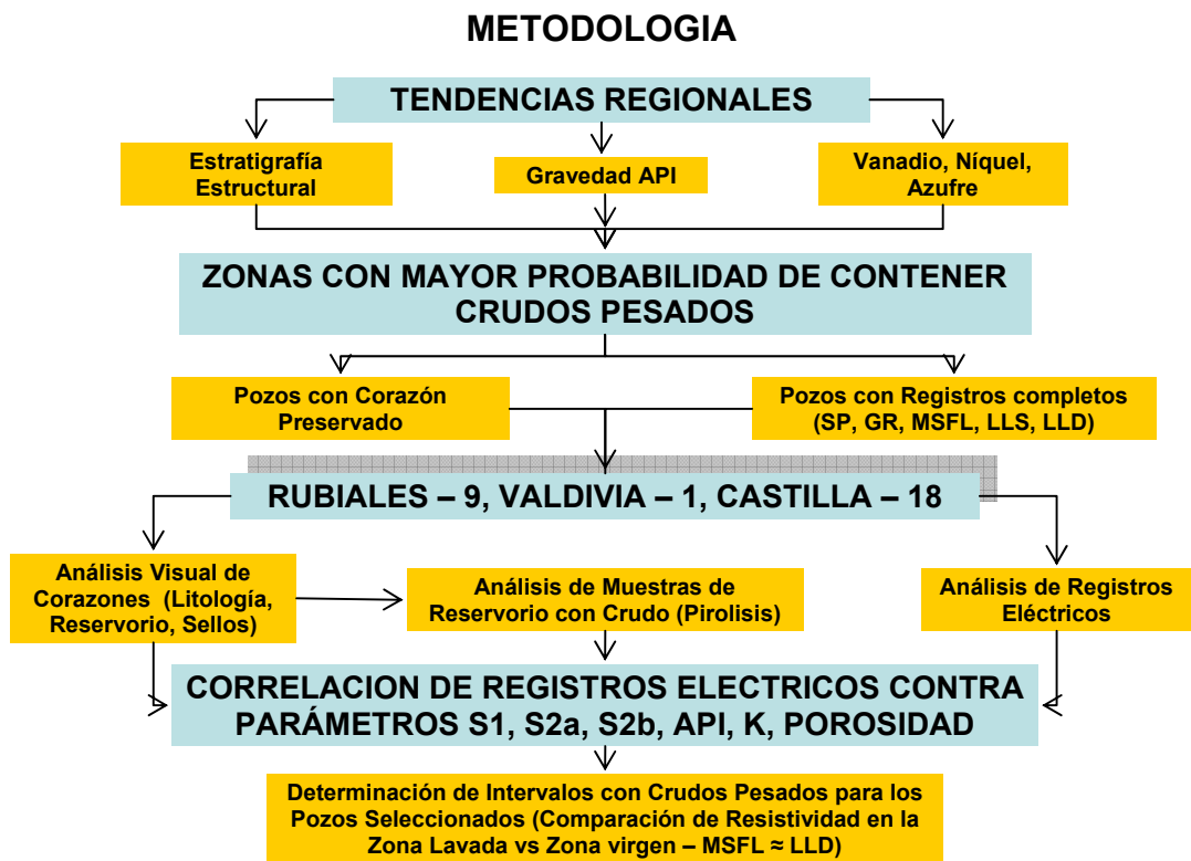
Figura 3. Integración de la Petrografía, de la Geoquímica Orgánica y de los Registros de Pozo para el Análisis de Crudos Pesados
