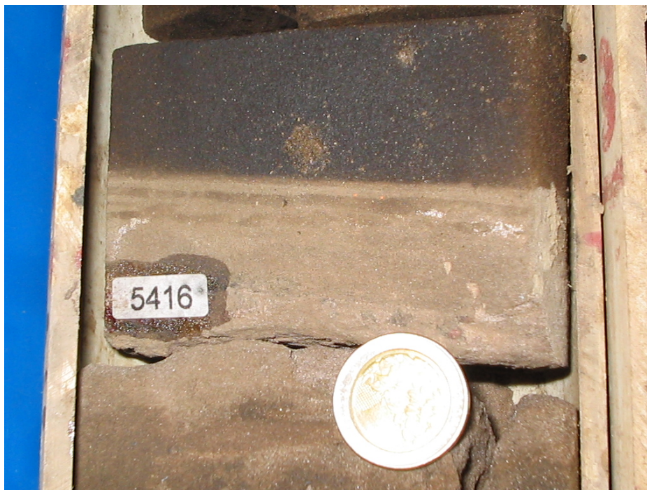
Figura 35. Barrera de permeabilidad dada por la variación en el contenido de matriz dentro de la arenisca de grano muy fino.
