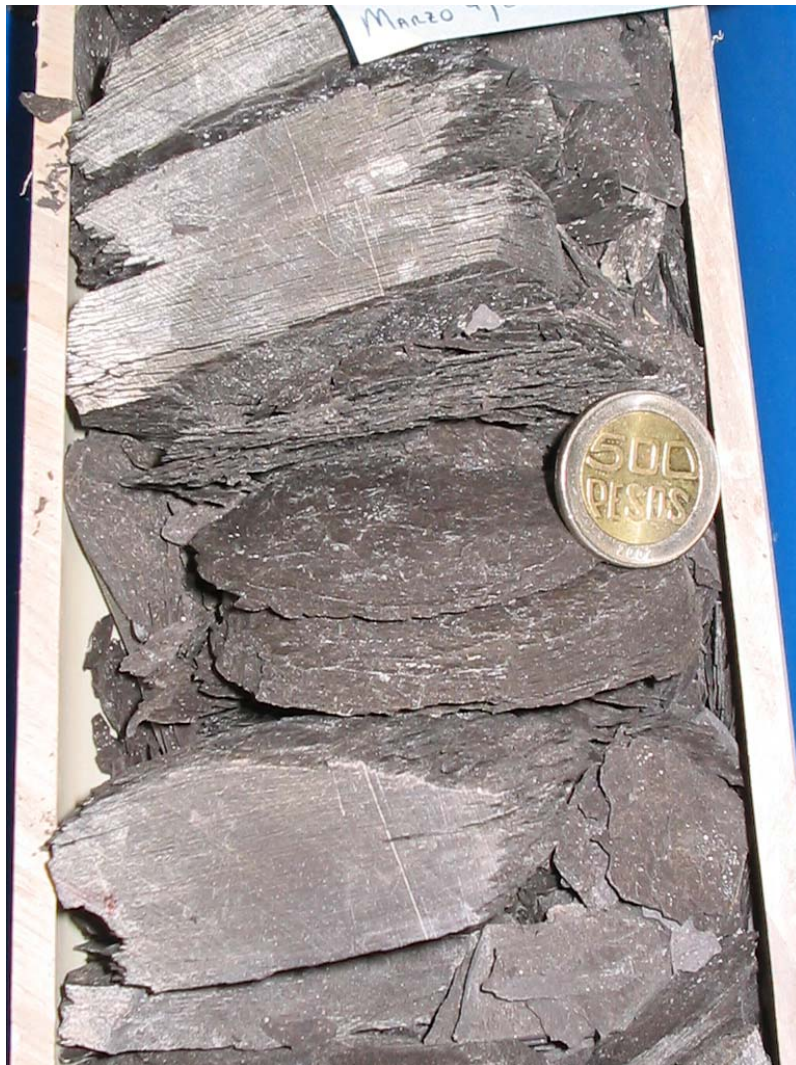
Figura 34. Arcillolita negra laminada bastante fisil que actúa en algunos sectores como roca sello.
