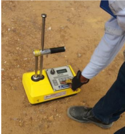
Figura No. 7 Toma de densidades con densímetro nuclear.
