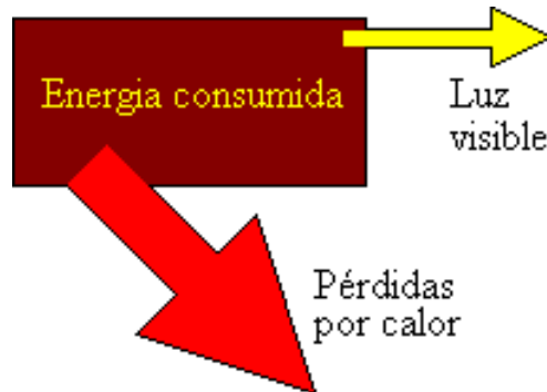
Figura.2 Rendimiento de una lámpara incandescente.
