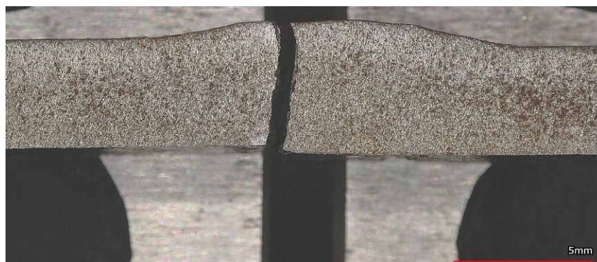
Figura 28 Falla de la probeta en el ensayo de fatiga.
