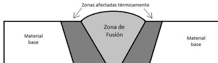
Figura 9 Zonas del cordón de soldadura.
