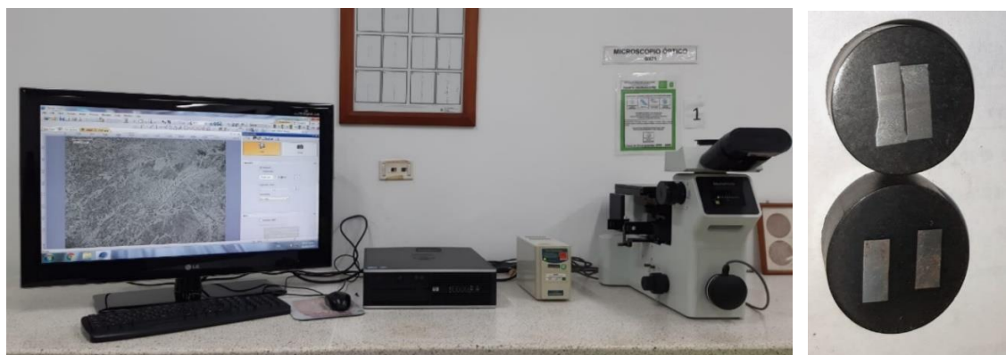
Figura 24 Microscopio y probeta usados para observar la microestructura.
