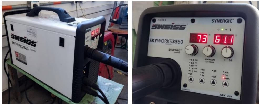
Figura 17 Equipo de Soldadura SWEISS SKY WORKS 3550.
