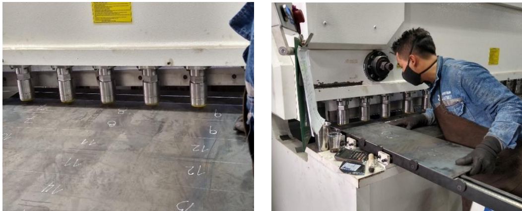
Figura 16 Máquina ALPMAC MODEL V, cizallamiento de la lámina de acero estructural ASTM A36.
