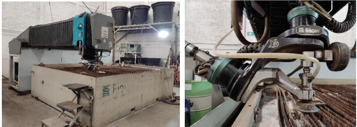
Figura 20 Máquina corte por chorro de agua FLOW MACH 3 .
