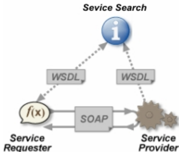
Figura 2.9 – Diagrama de Funcionamiento de un Web Service
