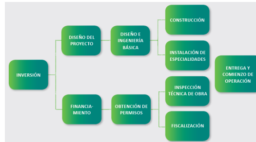
Figura 2. Mapa tipo de proceso operacional de la construcción de edificaciones.
