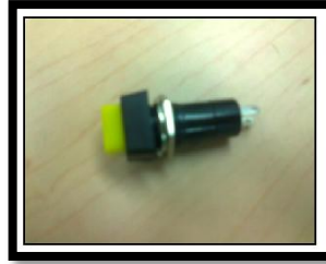
Figura 23. Pulsador para parada de emergencia
