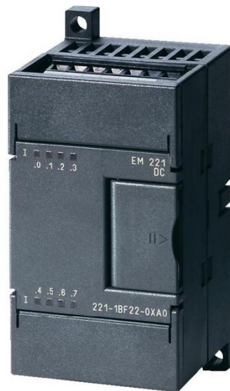
Figura 37. EM 221 DC de siemens (8 entradas digitales a 24V)
