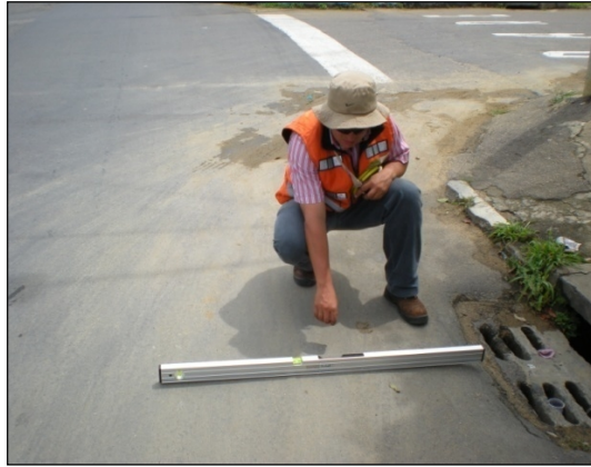
Figura 9. Medición de pendientes con inclinómetro.
