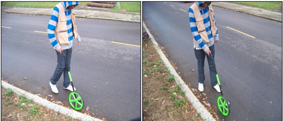
Figura 8. Medición con Odómetro, Comisión de Abscisado
