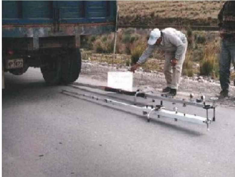
Figura 23. Imagen de deflexión tomada con viga benkelman
