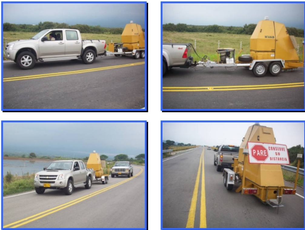
Figura 20. Equipo para toma de Deflectometría FWD KUAB
