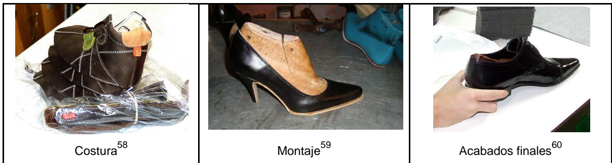
Figura 20. Costura, montaje y acabados finales de un zapato.
