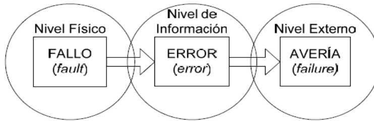
Ilustración 9: Simplificación de la relación entre fallos, errores y averías
