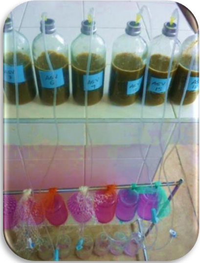
Medición de \text{CH}_4 por el método de desplazamiento alcalino
