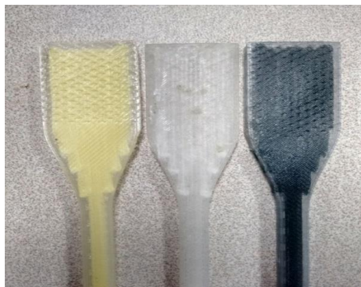
Figura 6. Probetas reforzadas con fibra de Kevlar®, vidrio y carbono
