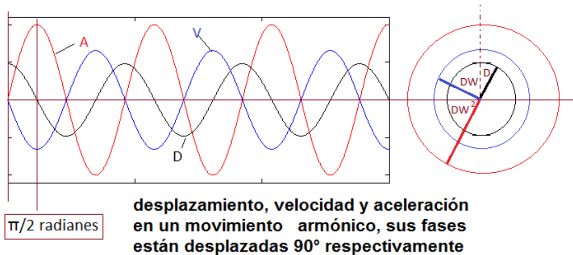
Figura 16 Relación entre desplazamiento, velocidad, y aceleración en un movimiento armónico.
