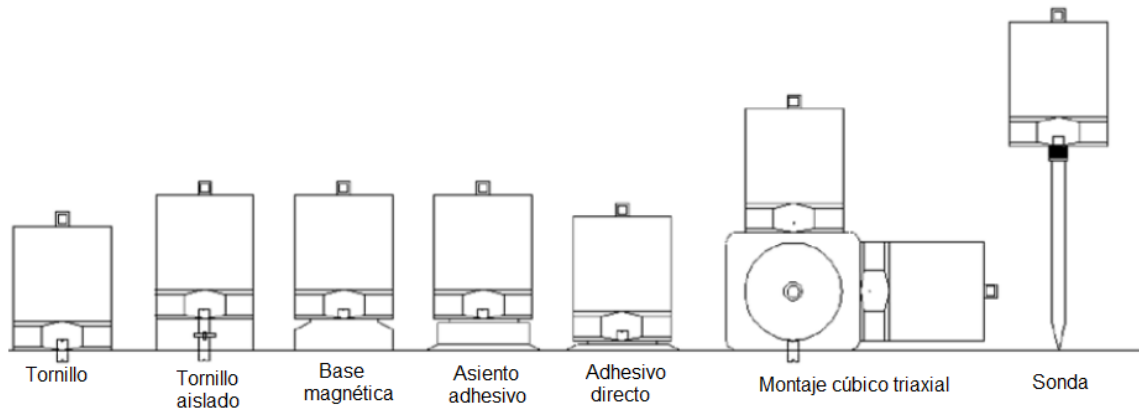
Figura 42 Métodos de montaje del acelerómetro
