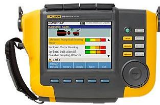
Figura 25 Sistema colector analizador de vibraciones Fluke 810
