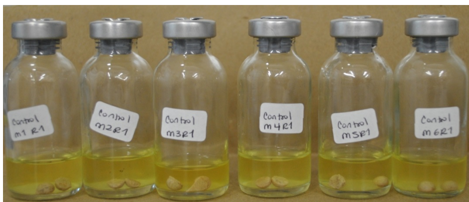
Imagen 1. Microcosmos empleados para la evaluación de la degradación de pentolita.
