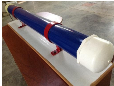
Figura 2. Tubo de impedancia o de Kundt.
