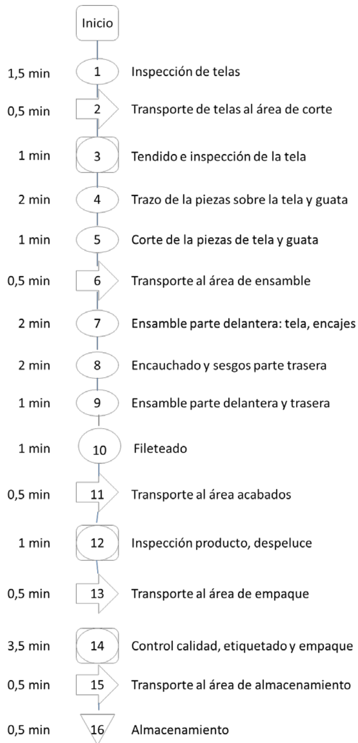
Figura 5. Diagrama de operaciones para la elaboración de un hípster
