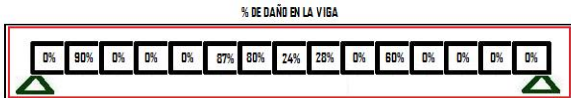
Figura 99. Viga simplemente apoyada con quince particiones con daño. (Elemento 2,6,7,8,9,11 con daño del 90%,87%,80%,24%,28%,60% )
