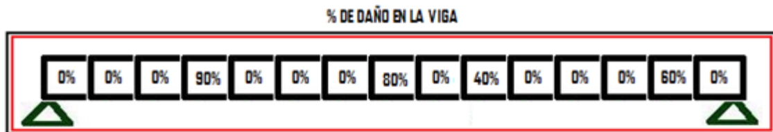
Figura 98. Viga simplemente apoyada con quince particiones con daño. (Elemento 4,8,10,14 con daño del 90%,80%,40%,60% )
