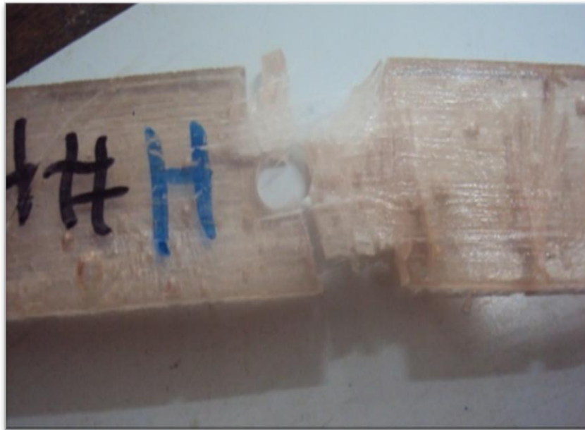
Fotografía 7. Modo de falla con desprendimiento de material en Probeta Hilo Agujero centro
