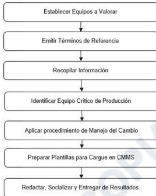
Figura 7. Diagrama de proceso de identificación de equipo crítico de producción.
