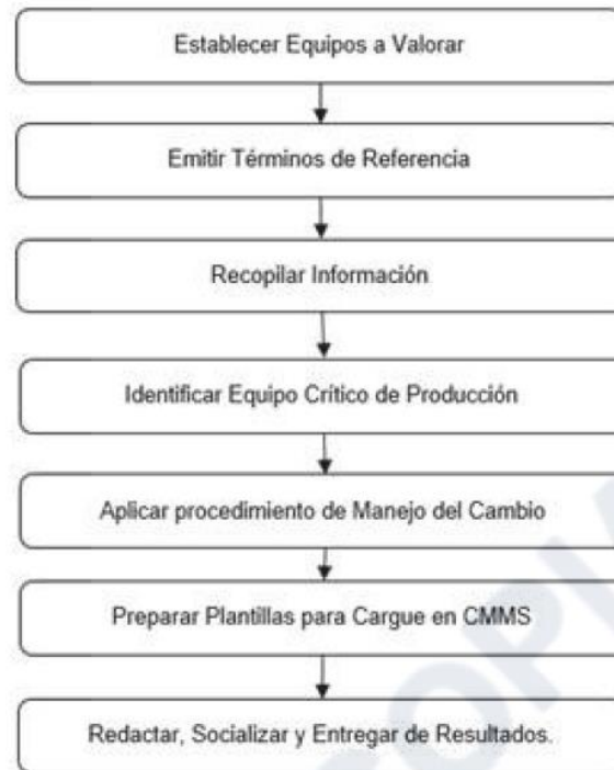
Figura 9. Diagrama de proceso de identificación de equipo crítico de seguridad de proceso.
