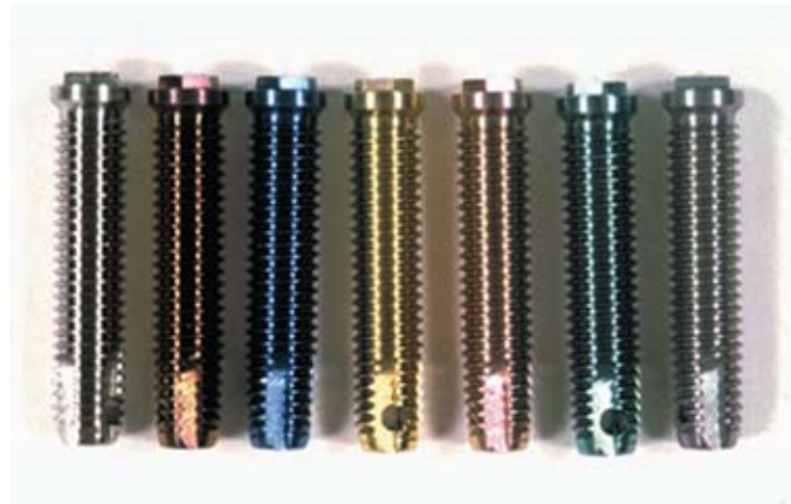
Figura 4. Relación de los colores formados sobre un ánodo de titanio en ácido sulfúrico 1M respecto al espesor del óxido y el voltaje de anodizado [7]
