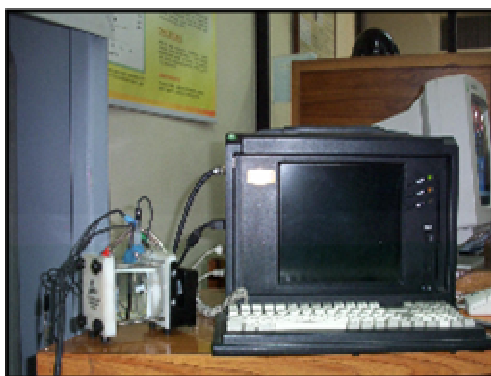
a) Celda conectada al GAMRY
