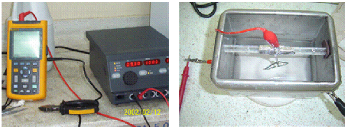
Figura 15. Montaje de la conexión entre la fuente de potencia y el osciloscopio FLUKE.
