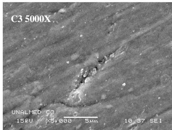
Figura 23. Microscopía Electrónica de Barrido para muestras anodizadas en 0.01M de \text{NaH}_2\text{PO}_4 \cdot 2\text{H}_2\text{O} a 100 V 15 Min (C3) y 200 V 15 Min (C2) a 2500 y 5000 aumentos.
