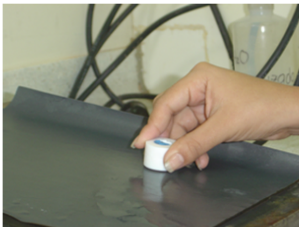
Figura 12. Preparación superficial de las probetas de ensayo. Desbaste mecánico
