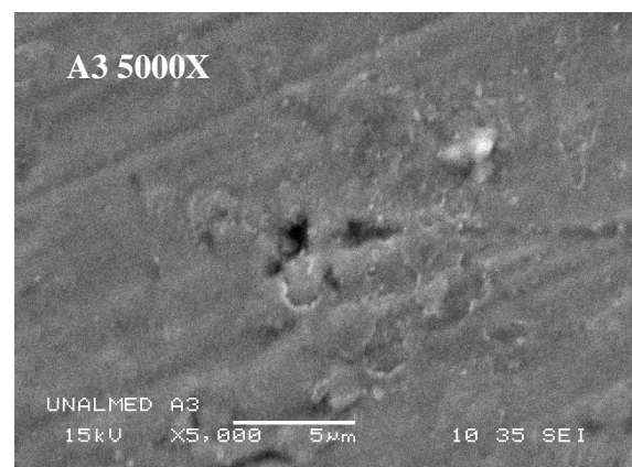
Figura 34. Microscopía Electrónica de Barrido para muestras anodizadas a 100 voltios durante 15 minutos, H_2SO_4 (A3), H_3PO_4 (B3) y NaH_2PO_4 \cdot 2H_2O (C3) a 2500 y 5000 aumentos.
