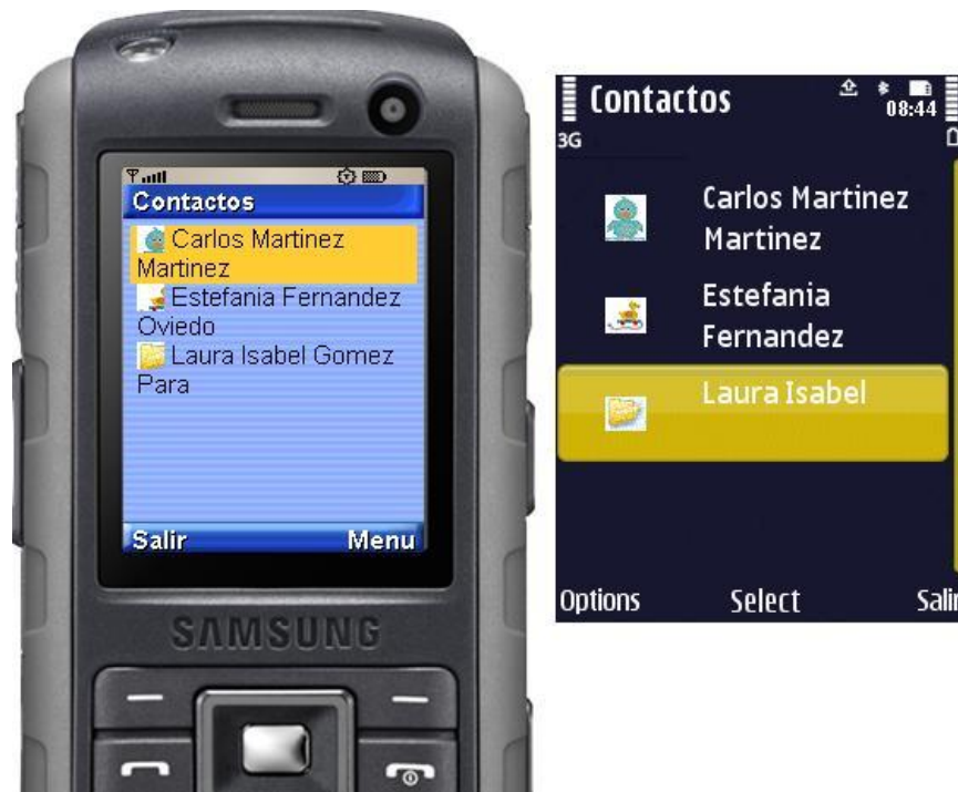
Figura 2-6: Interfaz de usuario LCDUI en dispositivos de diferentes fabricantes
