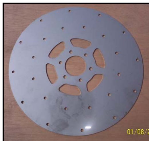
Figura 52. Disco Interior que Compone el Rodete Tesla.
