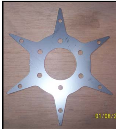
Figura 53. Separadores en forma de Estrella del Rodete Tesla
