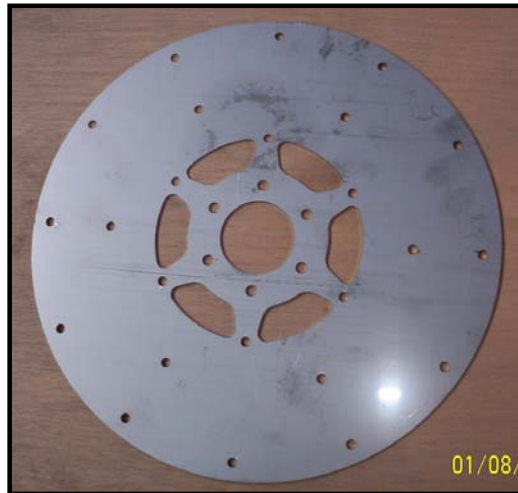
Figura 57. Separadores centrales del Rodete Phoenix
