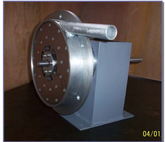
Figura 75. Ensamble Tapa Posterior, Anillo, Rodete Phoenix, Eje y Caja de Rodamientos
