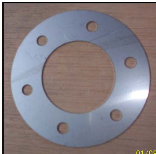
Figura 57. Separadores centrales del Rodete Phoenix
