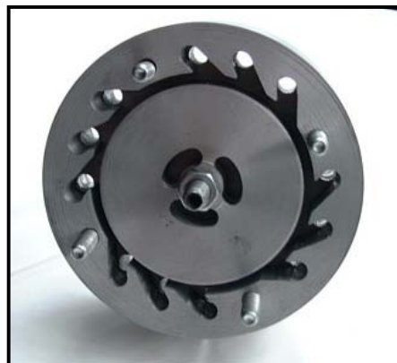
Figura 42. Diseño modificado de una turbina Tesla usada como compresor
