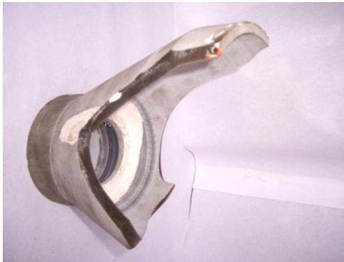
Fotografía 46. Fractura del contenedor cónico durante las pruebas
