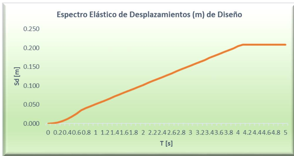
*Figura 37. Espectro sísmico de Desplazamientos.*
