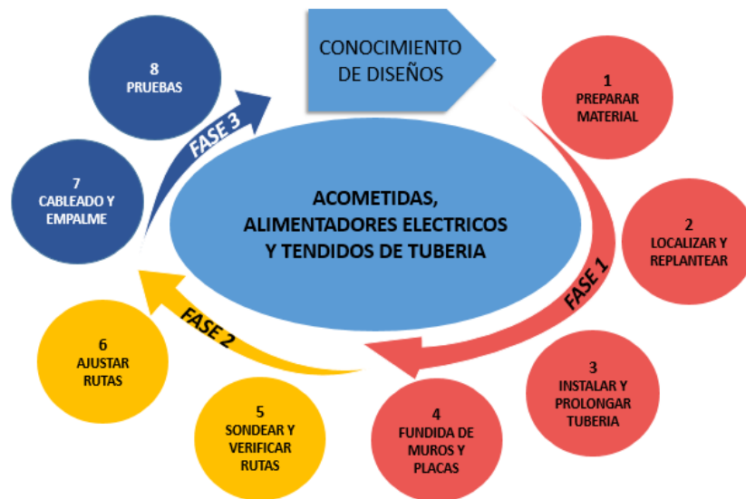
Figura 14. Proceso para la instalación de acometidas, alimentadores y tendidos de tubería.
