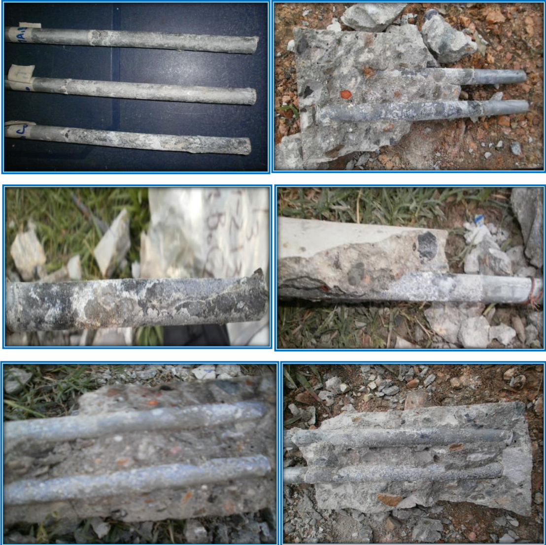
d) Inspección visual de las varillas de acero y su interface acero-concreto
