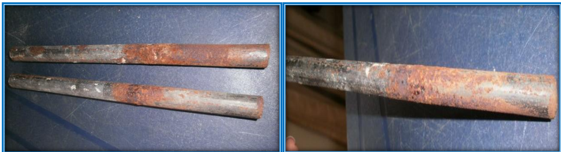
d) Inspección visual de las varillas de acero y su interface acero-concreto
