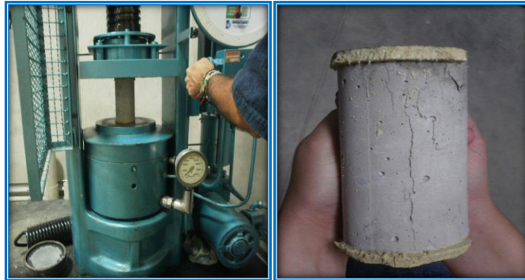
Figura 11. Ensayos de compresión.
