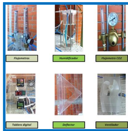
Figura 33. Otros componentes de la cámara de carbonatación.
