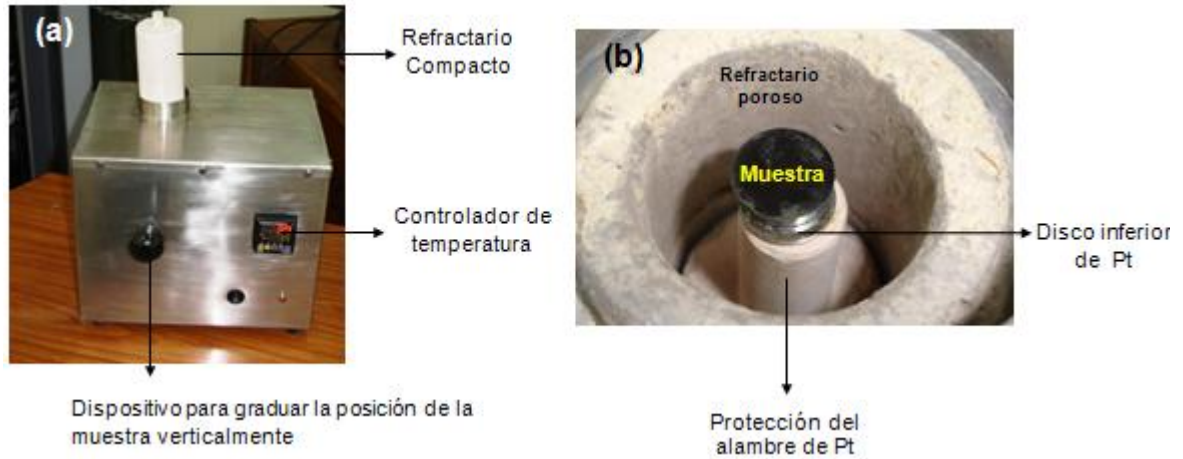
Figura 25. Horno-celda para ensayos de medición de impedancias (a). Posición de la muestra sobre el disco de Pt dentro de la cámara del horno-celda (b).
