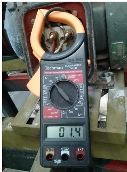
Como es evidente en la figura anterior las pinzas amperimétricas están marcando 1,4 amperios, lo cual indica que el motor trabaja muy suave en el arranque estando el molino en vacío, se procede a cargar el molino con el producto a moler para realizar más pruebas donde se evaluarán parámetros como capacidad de molienda, corriente y el comportamiento con diferentes cribas y granos.
