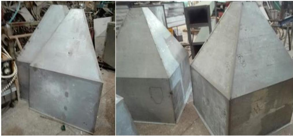
**Figura 62.** Sección superior y ensamble de las tolvas.
