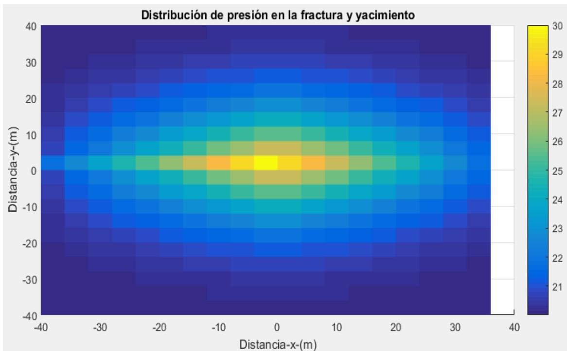
Figura 29: Distribución de presión en plano de fractura y yacimiento, luego de un minuto con la misma área de la fractura horizontal.
