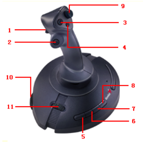
Figura 3.7: Características del Joystick utilizado para mover el brazo robótico
