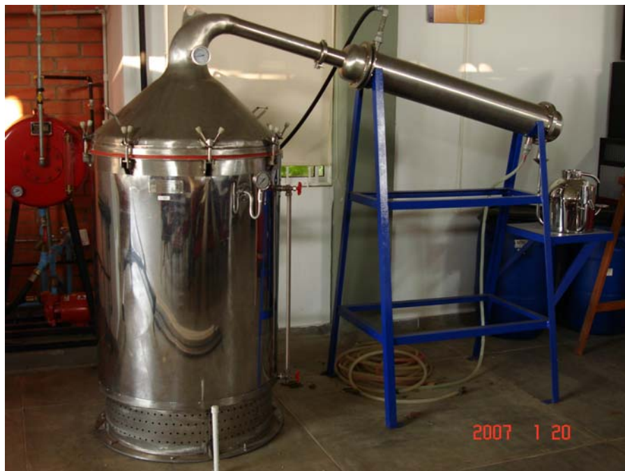
Vista general del equipo de destilación para la extracción de aceites esenciales ubicado en el CENIVAM
