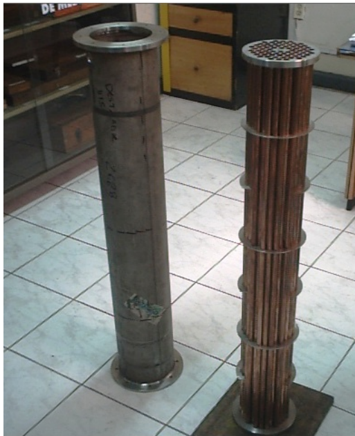
Carcaza y has de tubos del condensador.
