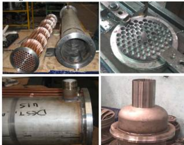
Figura 36. Construcción del condensador
