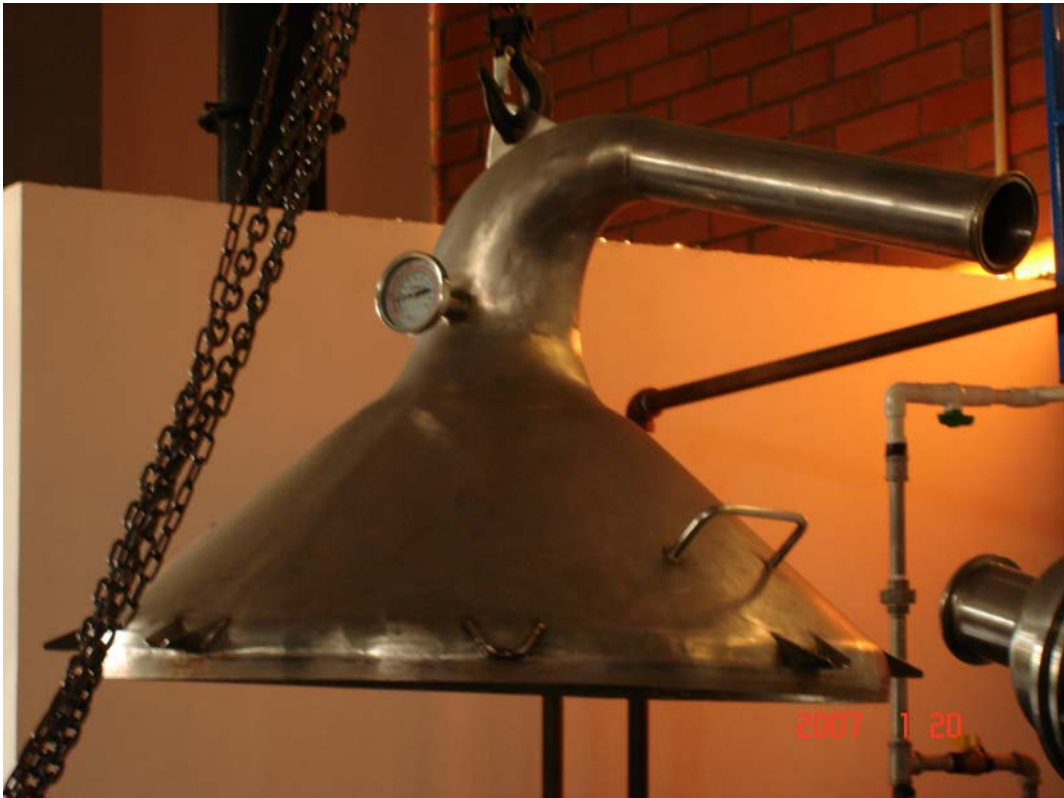
Cuello de cisne suspendido de la grúa construida para este propósito.
