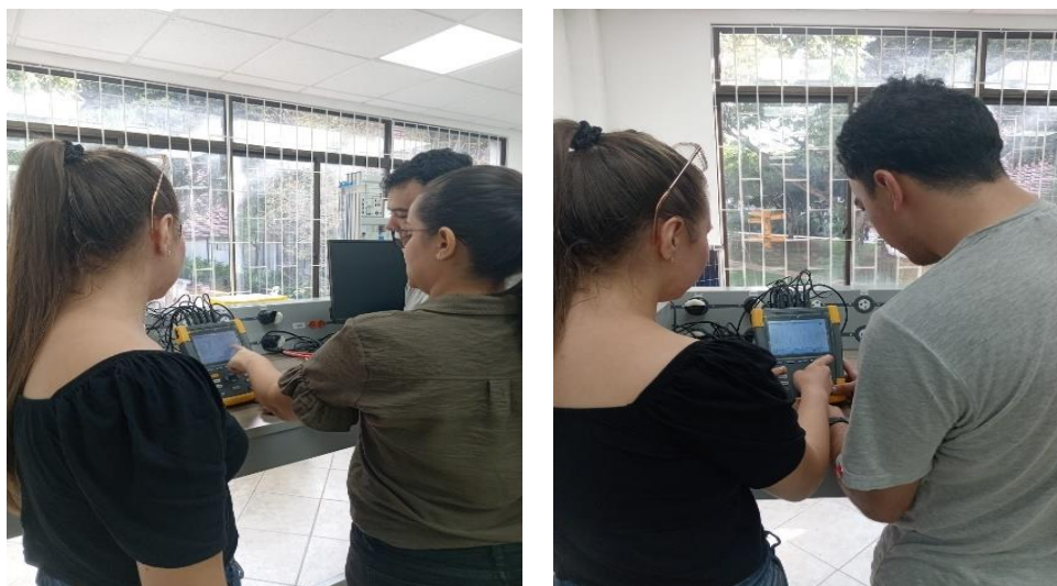
Figura 3. Conexión del analizador de redes en el laboratorio uso racional de la energía y energías renovables – 205.
