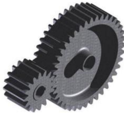
Figura 2. Sistema de transmisión de potencia por tren de engranajes.
