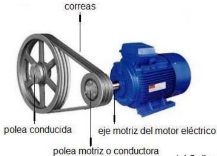
Figura 4. Sistema de transmisión de potencia por correas.
