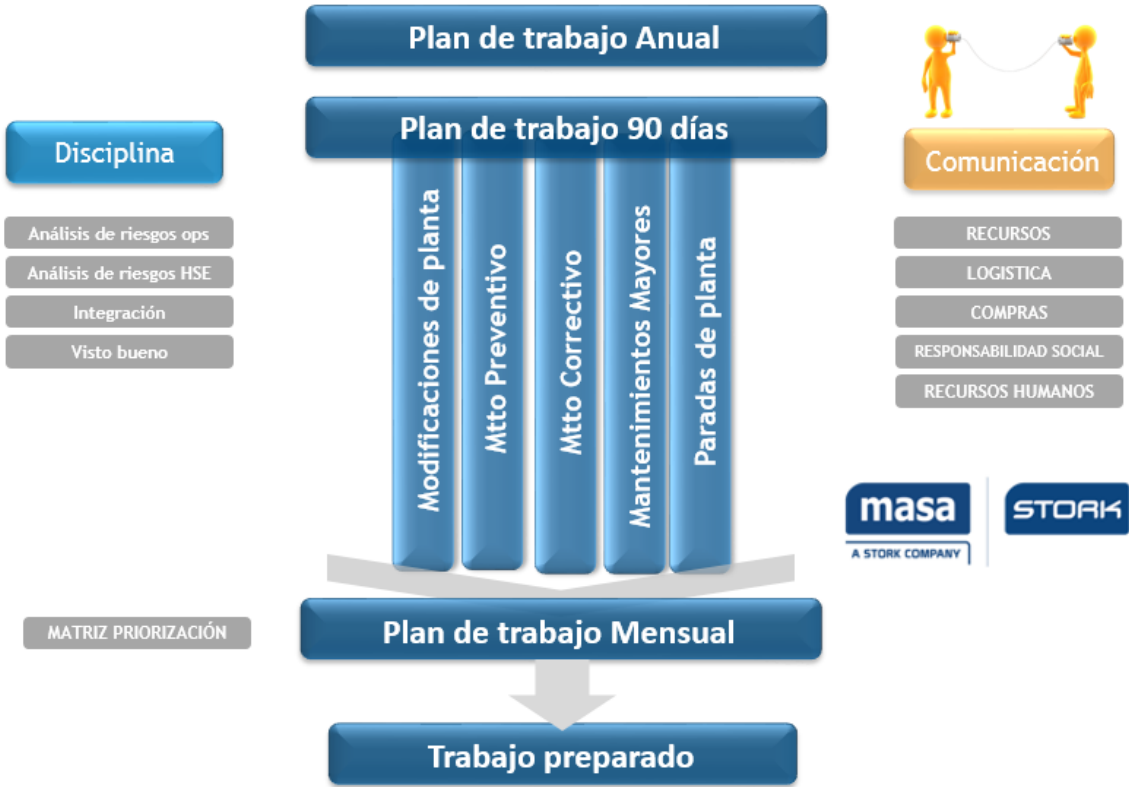
Ilustración 14 Modelo y metodología de planeación y preparación integrada y anticipada de trabajos de mantenimiento
