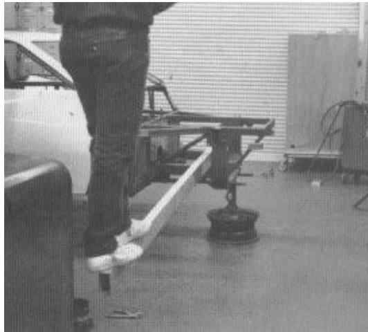
Figura 43. Medida experimental de la rigidez torsional.
