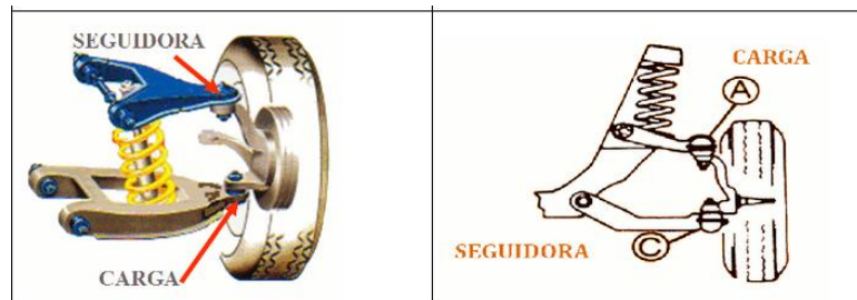
Figura 88. Ejemplos de rótulas seguidoras para dos configuraciones diferentes.
