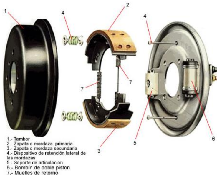
Figura 29. Partes del freno de tambor.
