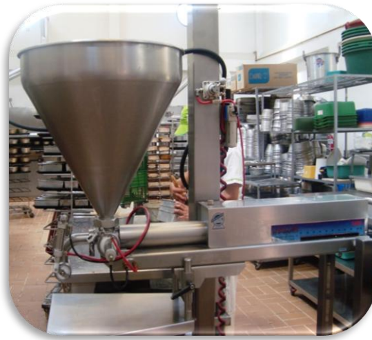
Fotografía D6. Dosificadora de líquidos y viscosos
