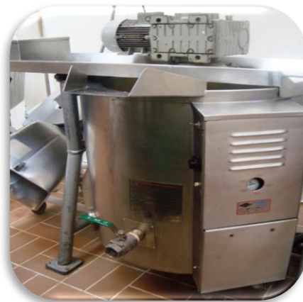
Fotografía D4. Marmita autogeneradora a gas
