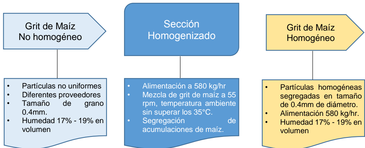
Figura 17. Esquema de entrada y salidas sección homogenizado
