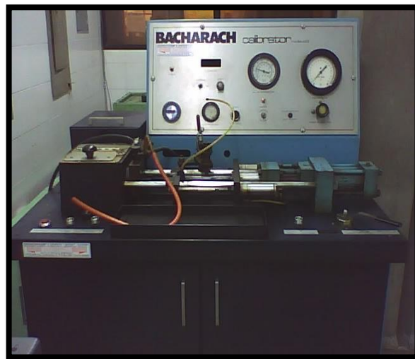
Figura 28. Banco para inyectores unitarios
