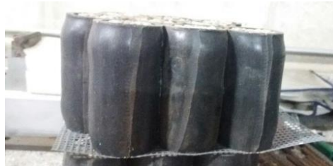
Figura 10. Malla 3x3 después del ensayo a compresión.
