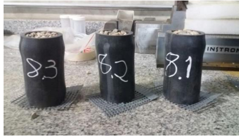
Figura 11. Tubos individuales después del ensayo a compresión.
