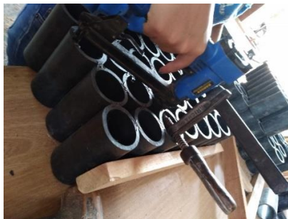
Figura 6. Unión de tubos mediante grapas.
