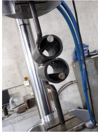
Figura 13. Ensayo a tracción con tubos atornillados y grapados.
