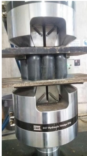
Figura 9. Ensayo a compresión malla 3x3.
