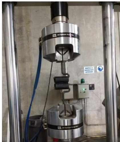
Figura 12. Ensayo a tracción con tubos grapados.
