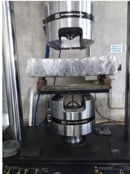
Figura 15. Ensayo a flexión malla 2x8.
