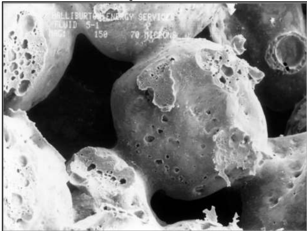
Figura 15. Efecto de consolidación de los granos.
