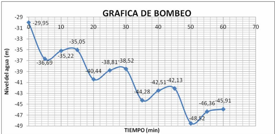
Grafico 6. Prueba Final. Bombeo Pozo Profundo Parque la Flora.
