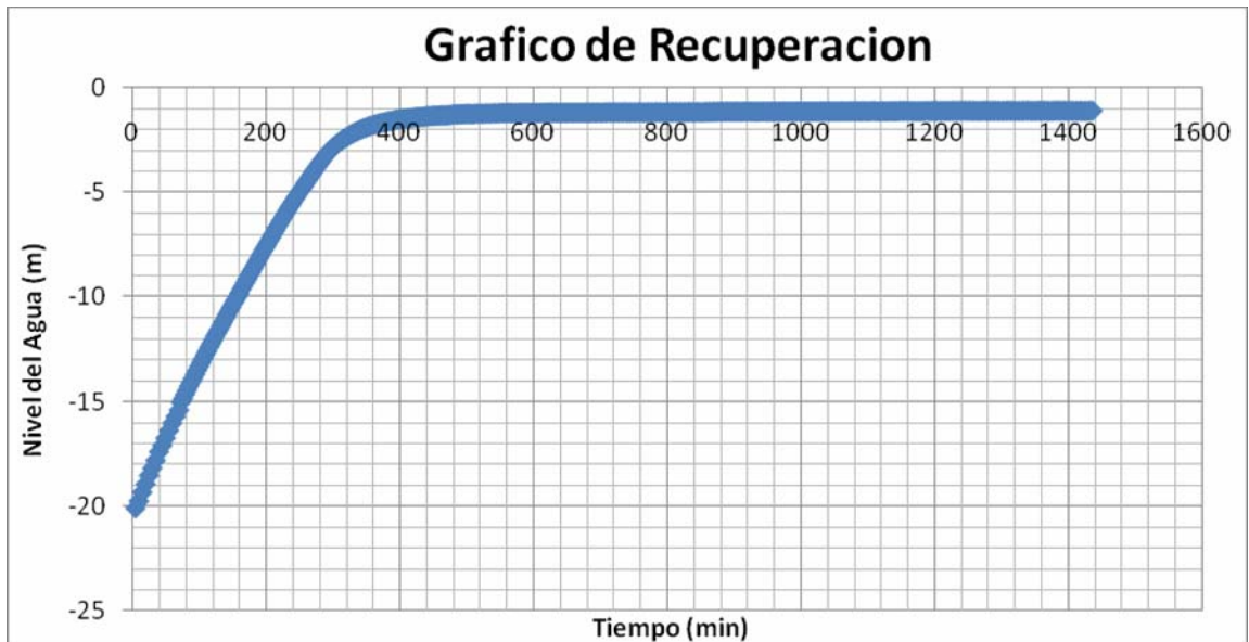
Gráfico 11. Prueba Final. Recuperación Pozo Superficial Parque la Flora
