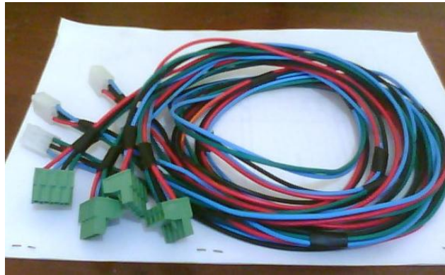
Figura 150. Cables de extensión de los motores paso a paso.
