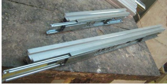
Figura 116. Ensamble de los perfiles en los dos tipos de módulos.
