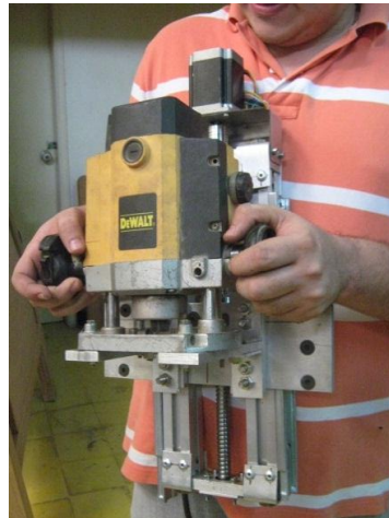
Figura 141. Montaje de la ruteadora en el módulo de 40 cm.
