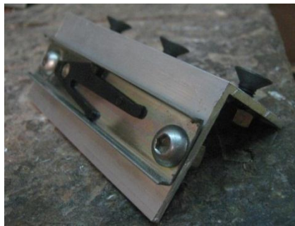
Figura 120. Ensamblaje de riel con las L de unión a la mesa deslizante.
