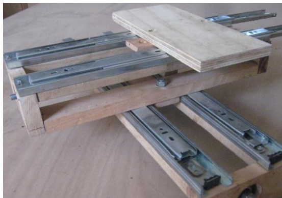
Figura 37. Montaje de dos módulos madera.
