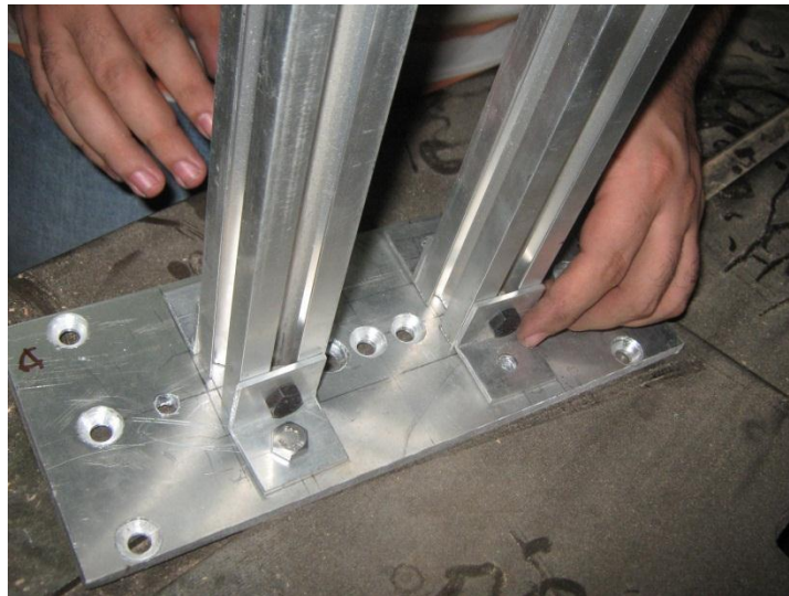
Figura 139. Montaje de los perfiles estrella soporte del módulo Z de 40 cm.
