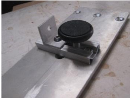
Figura 148. Esquema de sujeción del alambre de corte de icopor.
