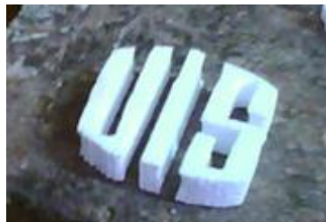
Figura 173. Resultado del corte de hilo. Prueba 1.
