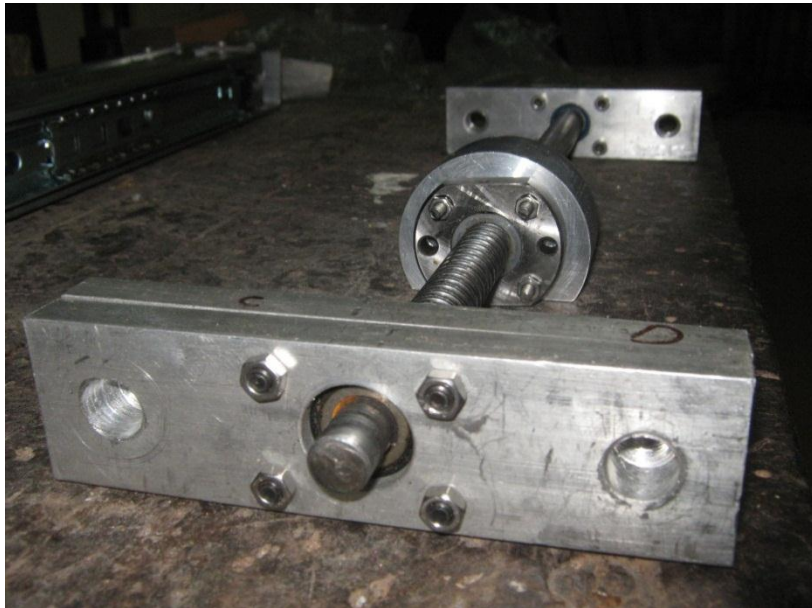
Figura 128. Ensamble de los tornillos de potencia dentro de las balineras de los módulos.
