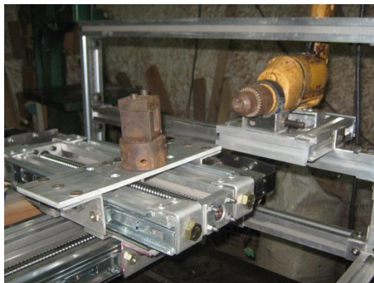
Figura 135. Ensamble del soporte del taladro. TORNO.
