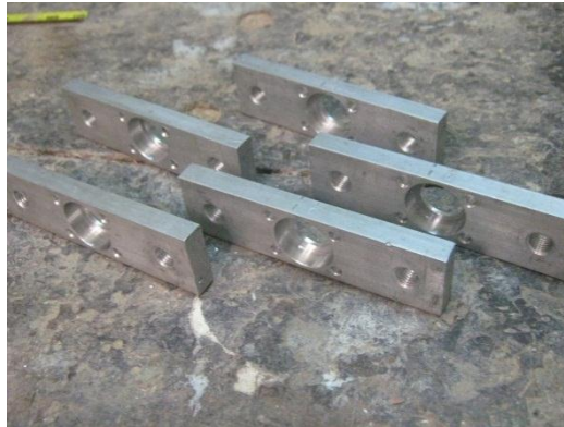
Figura 119. Mecanizado de las placas porta rodamientos.
