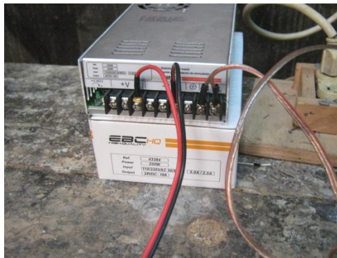
Figura 151. Conexiones de la fuente de alimentación de 24V.
