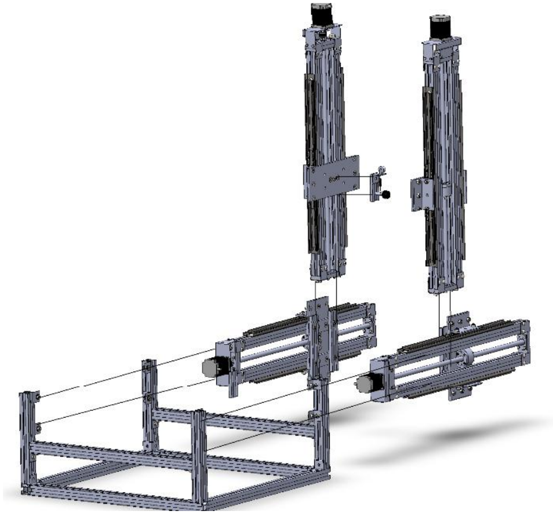
Figura 62. Montaje de corte de hilo caliente completo.
