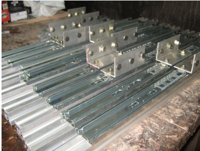
Figura 122. Montaje de las L en los rieles con el perfil estrella.
