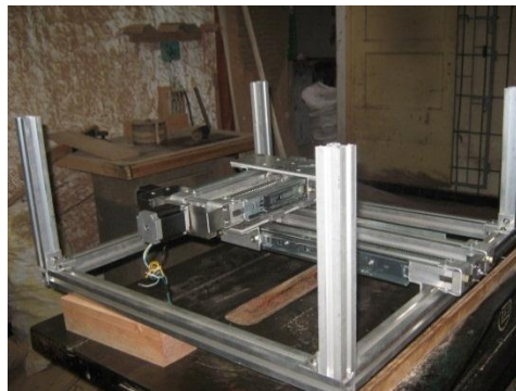
Figura 134. Ensamble del módulo de 40 sobre el de 80 TORNO.
