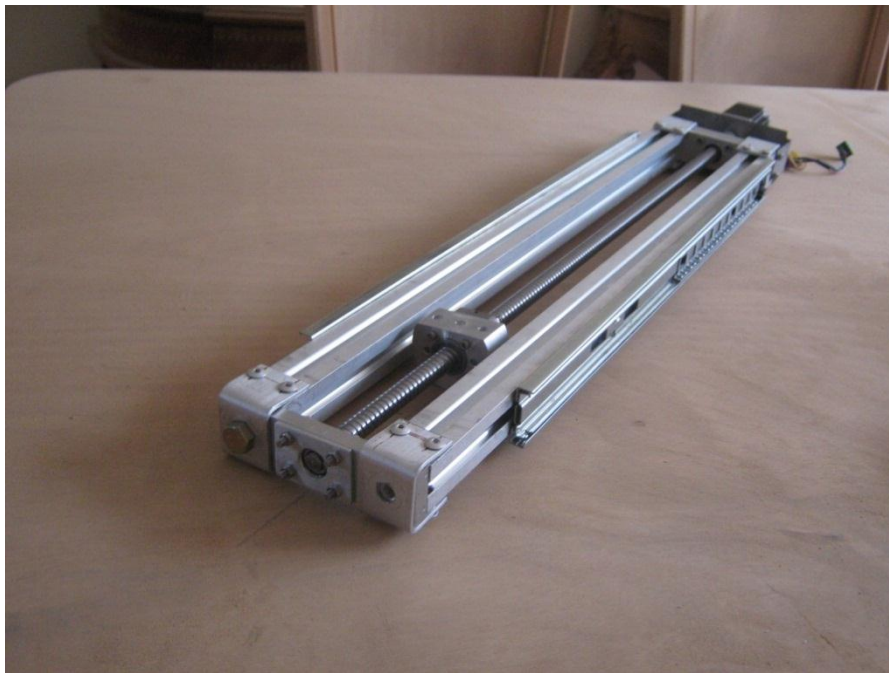
Figura 130. Ensamble completo de los módulos de 80 cm.
