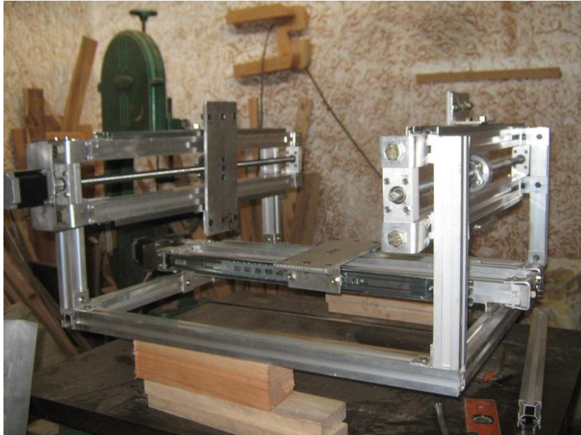
Figura 138. Montaje de los 3 módulos de 80 cm en la estructura FRESADO.
