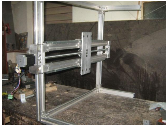
Figura 133. Ensamble de módulo de 80 cm en la estructura.
