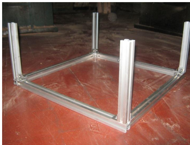
Figura 118. Armado de la estructura principal base.
