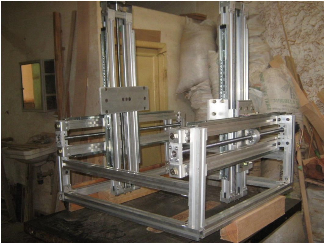
Figura 149. Ensamble completo de corte por hilo.
