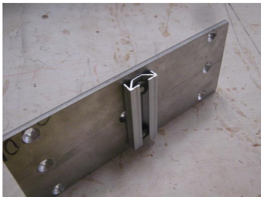
Figura 147. Ensamble de perfil media estrella para soportar en montaje del hilo.
