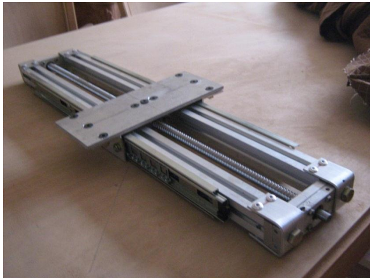
Figura 132. Ensamble de las mesas deslizantes en los módulos.
