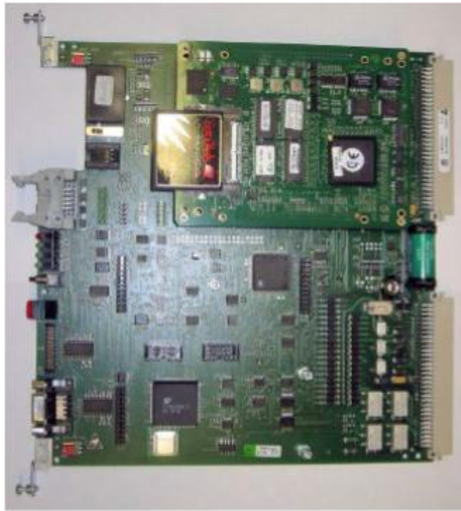
Ilustración 3. Módulo de control BBX y los módulos funcionales
