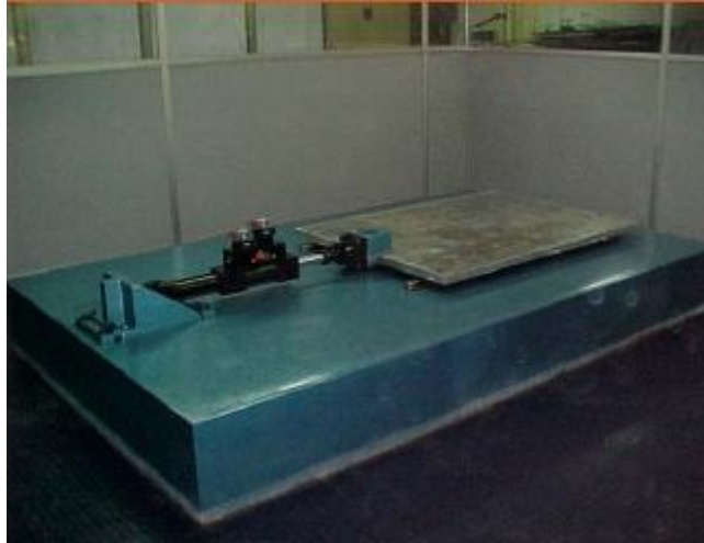
Figura 24. Alternativa 1 Shaking Table de la Universidad del Valle.
