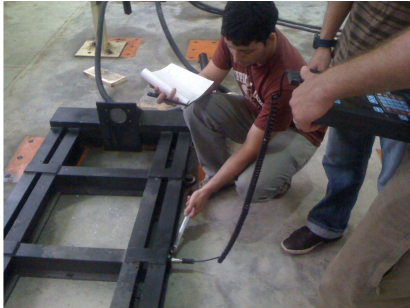
Figura 37. Medición experimental de la frecuencia natural de la estructura base.
