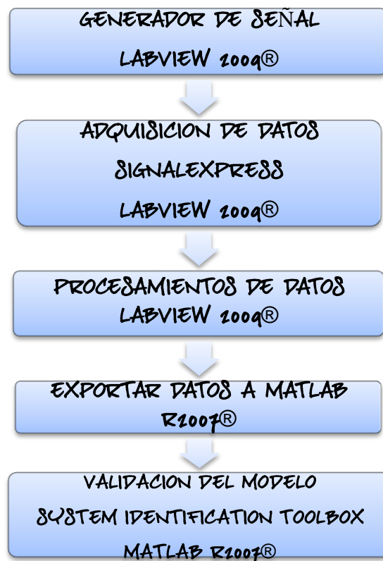
Figura 70. Esquema de proceso para obtener la respuesta a la frecuencia y la validación del modelo del servoactuador y su masa de prueba.
