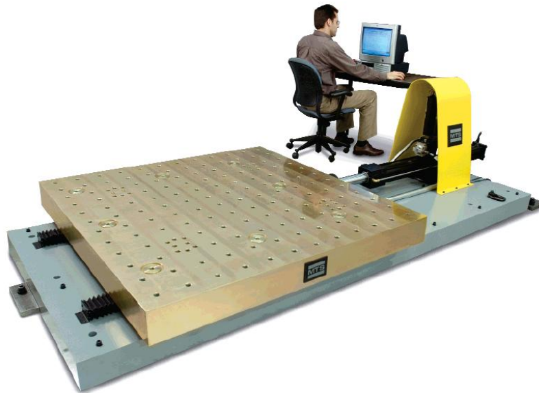
Figura 21. Mesa vibratoria uniaxial de 1.5 x 1.2 m fabricada por MTS Systems Corporation.
