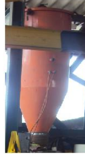
SILO DE ALMACENAMIENTO CICLÓNICO DE RECUPERACIÓN
