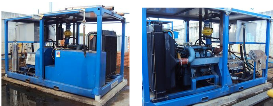
Figura 18. Equipo de lavado Hidrojet
