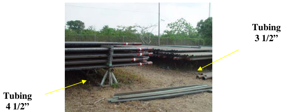
Foto 30. Tubería de Producción
